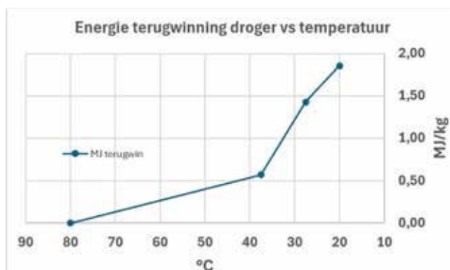
Figuur: Indicatieve hoeveelheid teruggewonnen warmte als functie van de temperatuur na de warmtewisselaar. Onder het dauwpunt neemt de warmteterugwinning sterk toe. Bron: TKT-rapport Energieopslag in wasserijen en stomerijen.
